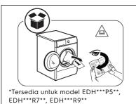
1 Untuk model EDH\*\*\*J5\*\*, Gunakan DRUM UNLOCKED KEY untuk membuka kunci Tabung Belakang, sebelum menggunakan peralatan. Untuk model lainnya, kunci tabung belakang dilepas secara otomatis saat pengering diaktifkan untuk kali pertama. Dapat terdengar suara bising.
